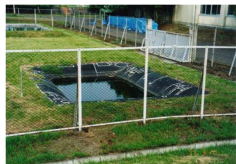
Fig.7 合成ゴム系ジオメンブレンで遮水された実験池 Test pond for the lining system with synthetic rubber geomembranes
